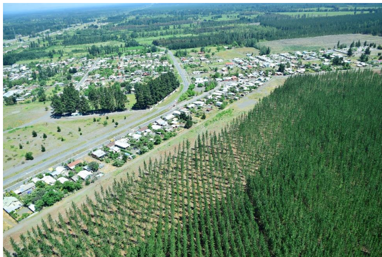
Figura 5. Franja con raleo, posterior a una barrera cortafuego Fuente: CONAF (2018)
