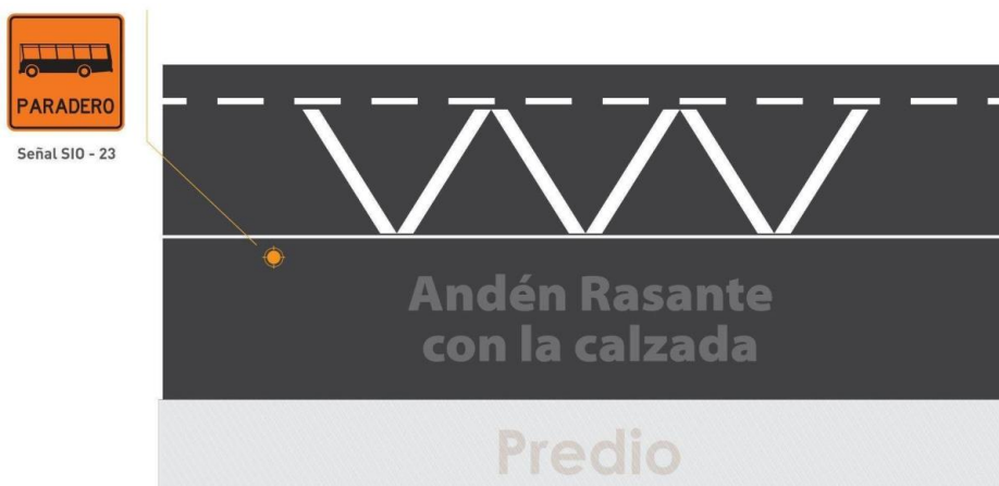
Imagen 62. Propuesta de demarcación paraderos temporales por obras. Fuente: elaboración propia.
