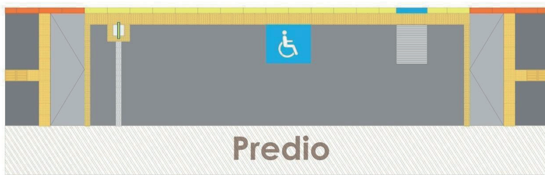
Imagen 21. Zona paradero con franja de mobiliario
